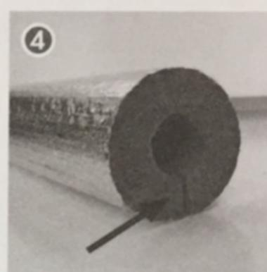
Zur Minimierung des Wärmeverlustes bei waagrecht Montage die Längsnaht so ausrichten, dass sich diese unten am Rohr befindet! <sup>1)</sup>
